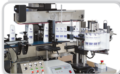
Stabilizzatore superiore utilizzato per guidare i prodotti in fase di etichettatura. Upper counter-roller: used for the product stabilization during labelling. Tapis supérieur: utilisé pour la stabilisation du produit pendant la pose de l'étiquette. Arrollador superior: utilizado para estabilir los productos en fase de etiquetado.
