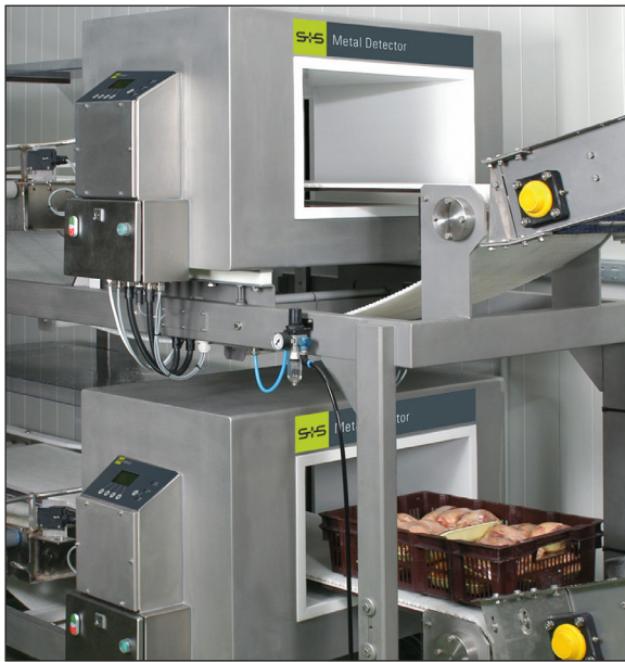
Ejemplo de instalación: Detector de metales GLS instalado en dos líneas de producción para la inspección de aves (versión antigua)
