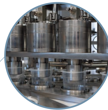
SISTEMA DE ELEVACIÓN DEL ENVASE PARA EL LLENADO DESDE EL FONDO DEL ENVASE LIFT SYSTEM FOR CONTAINERS TO ALLOW FILLING FROM THE BOTTOM OF THE CONTAINER SYSTÈME D'ÉLEVATION DE L'EMBALLAGE POUR LE REMPLISSAGE DEPUIS LE FOND DE L'EMBALLAGE
