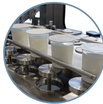
TRANSPORTADOR MOTORIZADO PARA LA SALIDA DE ENVASES POWERED CONVEYOR FOR PULLING OUT THE CONTAINER TRANSPORTEUR MOTORISÉ POUR L'EXTRACTION DE L'EMBALLAGE
