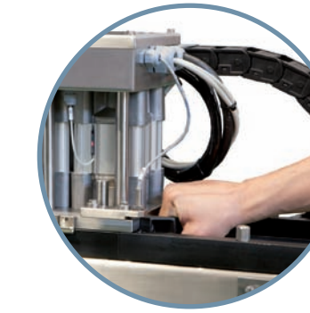
GRUPO DE SELLADO EXTRAIBLE PARA LIMPIEZA Y MANTENIMIENTO HEAT SEALING UNIT MANUALLY REMOVABLE FOR CLEANING AND MAINTENANCE SYSTÈME DE THERMO SCELLAGE AMOVIBLE MANUELLEMENT POUR NETTOYAGE ET ENTRETIEN
