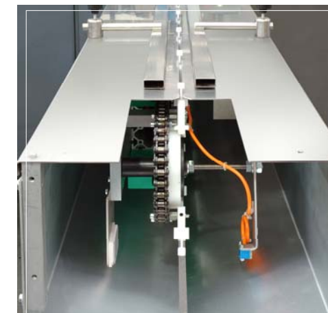
Cinta de alimentación con cadena desplazada
