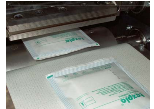
Grupo de soldadura y corte transversal
