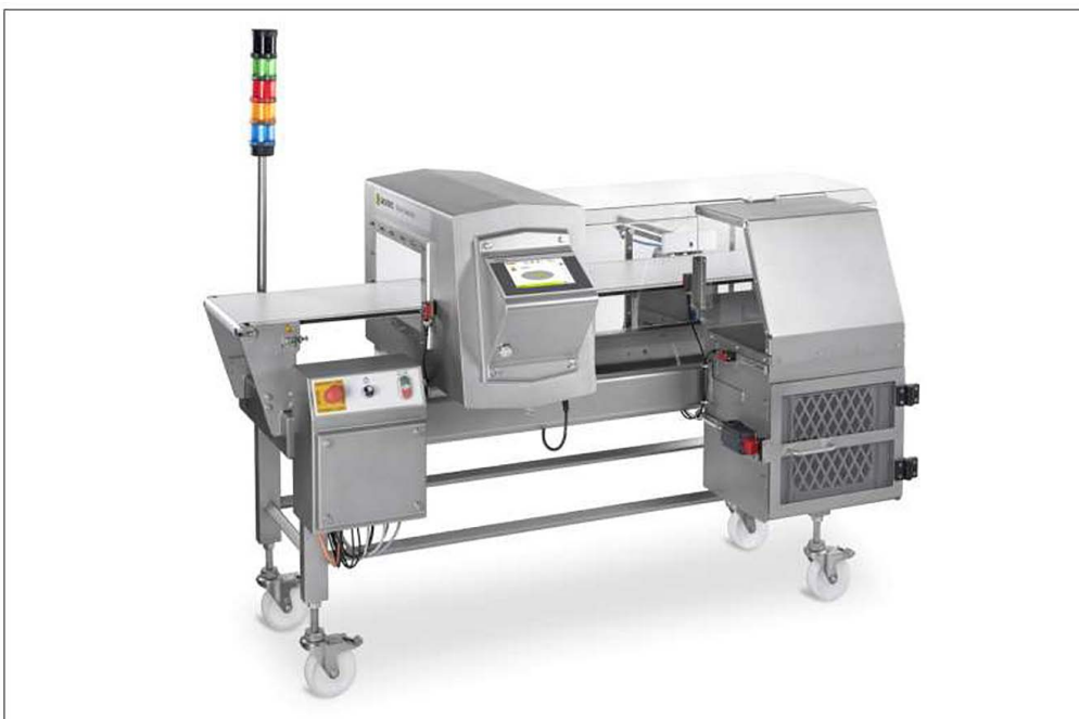
Sistema de detección de metales UNICON+ con detector de metales INTUITY integrado, unidad mecánica de rechazo y paquete opcional de seguridad de alto nivel para la inspección de salida de mercancías.
