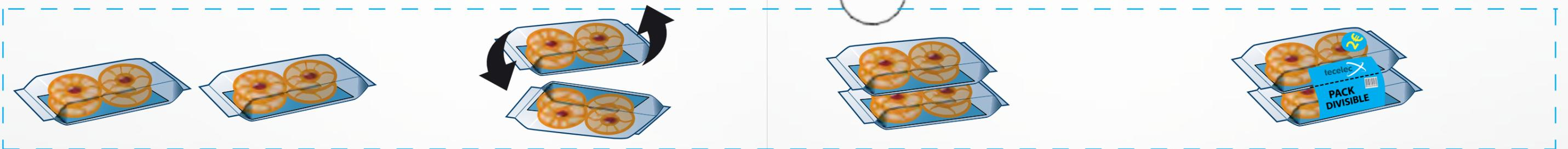
**CADENCIACIÓN** Los paquetes llegan al transportador y este los separa. Uno de ellos pasa directamente y el otro es empujado hacia la rampa para su volteo.
