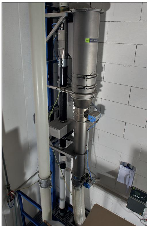
*Ejemplo de instalación: Separador de metales de la serie GF 4000 instalado en una tubería vertical de transporte a presión (versión antigua)*
