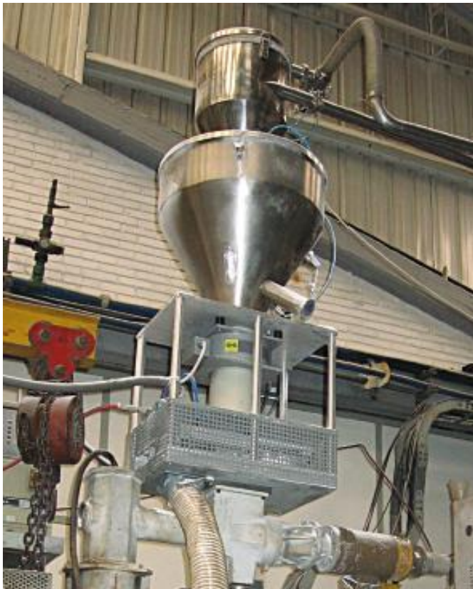
Ejemplo de instalación: Separador de metal instalado en la entrada de material. (versión antigua)
