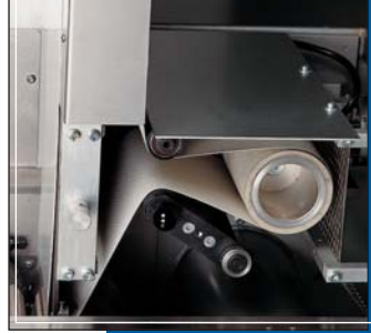
Grupo de soldadura y corte transversal Transversal sealing and cutting unit Groupe de soudure et coupe transversale
