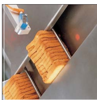
Fotocélula función NO PRODUCT-NO PAQUETE sensor device PhotoCellule avec fonction PAS DE PRODUIT-PAS DE SACHET
