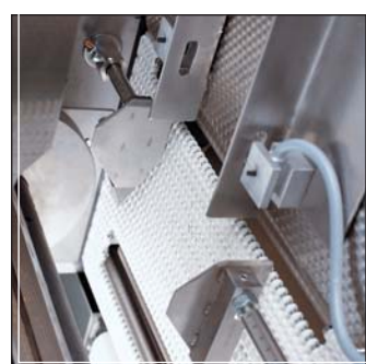
Fotocélula función NO GAP-NO CUT sensor device NO PASE-NO CORTE PhotoCellule avec fonction HORS DE PHASE-PAS DE DECOUPE
