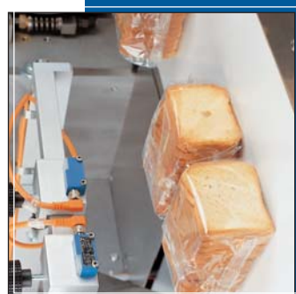
Conjunto expulsor de bolsas vacías y/o dobles Ejector for 1st section and reject of empty bag / for double pack Dispositif de déjection et rejet de sachets vides et/ou doubles
