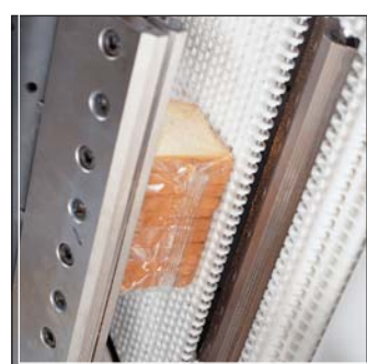
Cinta de arrastre motorizada en soldador - corredo / in the transversal sealing-cutting group Conveyor d'entraînement dans le groupe coupeur soudeur
