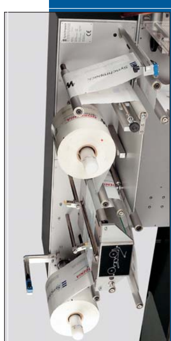
Conjunto para el empalme automático del film Automatic film splicing device Dispositif pour le raccordement automatique du film
