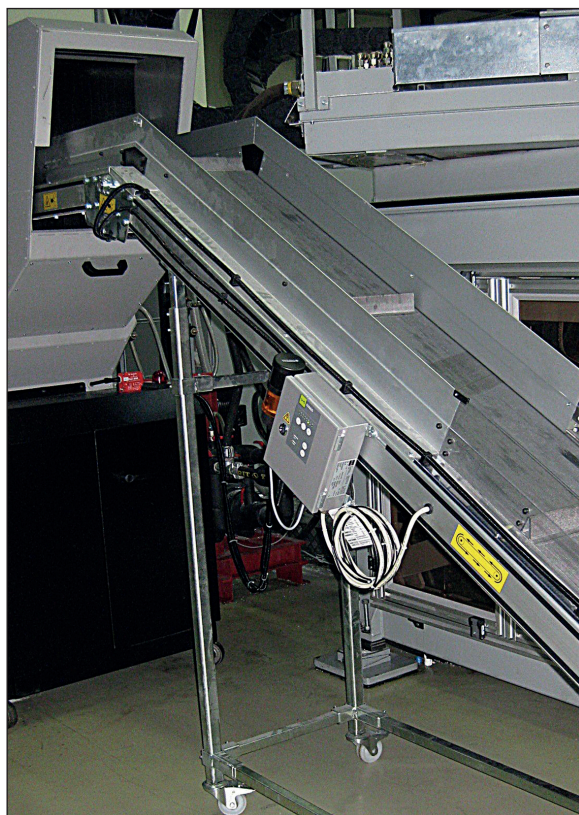
Ejemplo de instalación: Protección de molinos. El detector de metales plano ELCON instalado en la cinta de alimentación del molino. (versión antigua)
