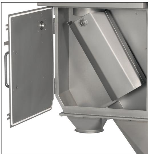
Unidad de separación con compuerta de limpieza abierta.
