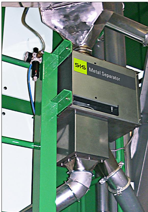
*Ejemplo de instalación: Separador de metales RAPID 4000 instalado para el control de calidad de verduras secas. (versión antigua)*
