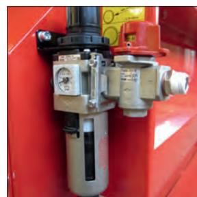
Aislador neumático (Solo para equipos con aire comprimido)
